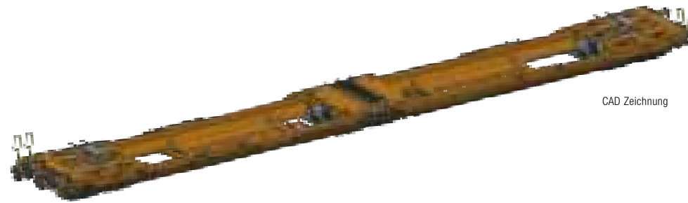
■ Stützbock in hoher Position für Auflieger und tiefer Position für Containerbeladung
